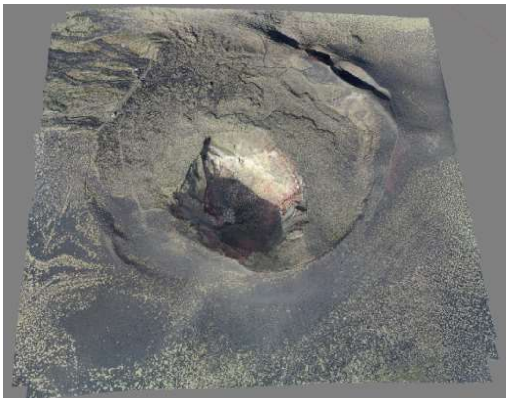
図 11 基準点 (GCP) を用いて位置補正を行った三原山火口の 3D モデル
